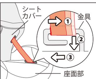
座部面シートカバーをめくり、左右の金具から①～③の順で肩ベルトを外し、本体から引き抜く。
