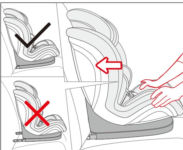
本体の背もたれが車両のシートに接するように調節し、ぐらつきがないか確認する。取付け後は、チャイルドシートと車両のシートの角度を調節しないで下さい。
