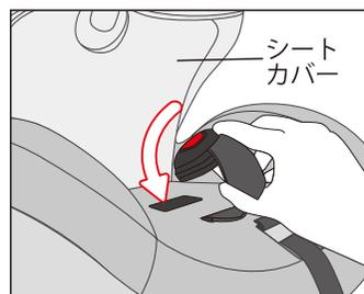
バックルを座部面シートカバーをめくった下にある収納穴に入れ込む。
