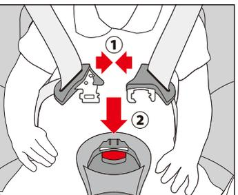
左右のタングを合わせ (1)、調節ベルトを引き、肩ベルトをバックルに「カチッ」と音がするまでまっすぐ差し込む (2)。ベルトに指一本入る程度が適切。
