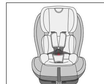
バックルを固定し、肩ベルトの動作・ヘッドシート・リクライニング角度等を再度調節する。
