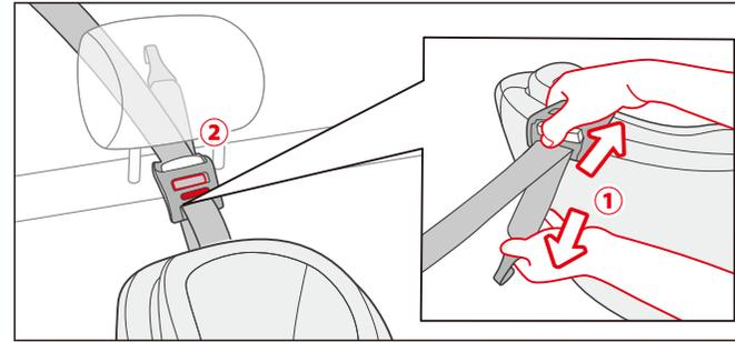
トップテザーを取り出す。テザーベルトアジャスタのボタンを押しながらベルトの長さを調節し (①)、ヘッドレストの下を通す (②)。
