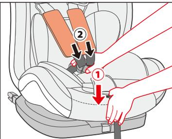
片方の手でベルト調節レバーを押さえながら (①赤矢印)、もう一方の手で肩ベルトを2本合わせて引っ張り調節します (②黒矢印)。
