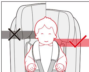
シート上部にあるヘッドシート調節ボタンを引き上げたまま、ヘッドシートを動かし高さを調節して下さい。ヘッドシートとお子さまの頭の位置をちょうど良い高さに合わせる事が重要です。
