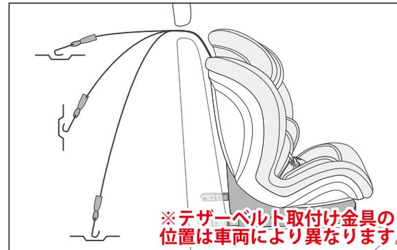
※テザーベルト取付け金具の位置は車両により異なります。トップテザー取付け金具にトップテザーをねじれがないように引っかける。
