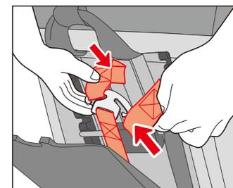
もう一方の肩ベルトを正面から差し込み、ねじれないよう金具に固定し、カバーを閉じる。
