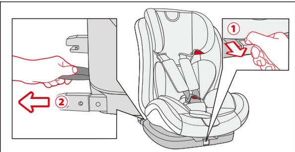
本体の底部にあるオレンジの ISOFIX 解除レバーを引っ張りながら (①)、同時にもう片方の手で底部後方にある黒いコネクタ引き出しベルトを引き ISOFIX コネクタを出す (②)。
