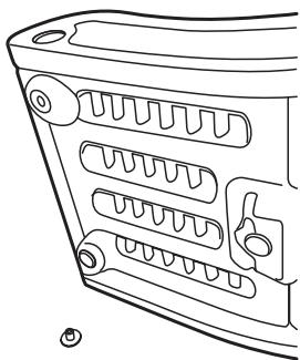
サブスロープ裏側の3箇所の穴にサブスロープ底ラバーを取付けます。
