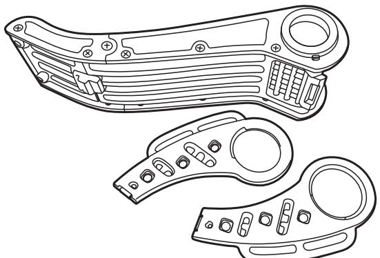
※1のサイドパネルの「突起部分」を手すり付階段パネルの※2の「折りたみ稼働スペース」の範囲内に合わせてめ込みます。
