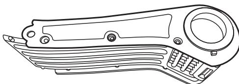
メインサイドパネルA・Bとメインスロープの穴の位置を合わせて、ナット小を付属の専用ドライバーで固定します。
