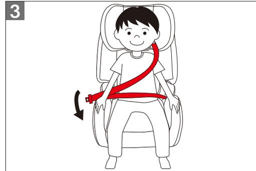
お子さまの腰にシートベルトを回し、車両のシートベルトバックルを留める。
