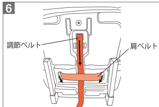
本体の底面が見えるように寝かせて置き、肩ベルトを抜く。調節ベルトはベルト調節ボタンを押しながら抜く。
