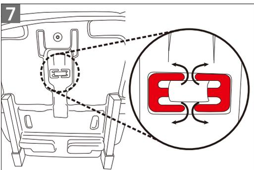
肩ベルトバックルは底面中央にある金具を矢印のように外し、上に抜き取る。
