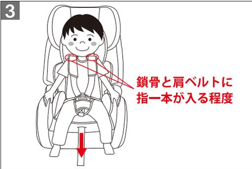
バックルを留め、調節ベルトを引いて肩ベルトを調節する。
