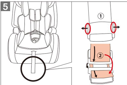
調節ベルトの先端のストッパーを外す。
