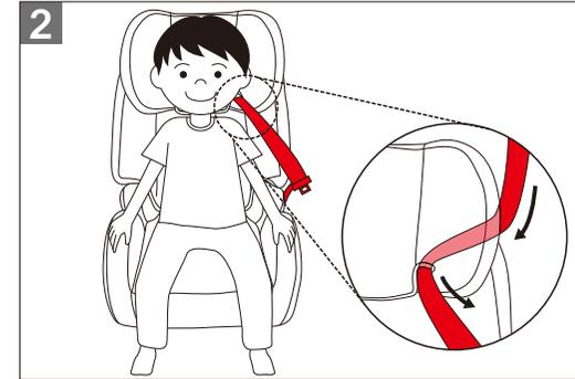
シートベルトを引き出し、ヘッドクッション左右それぞれ下側に付いているシートベルトガイドフックにシートベルトを通す。
