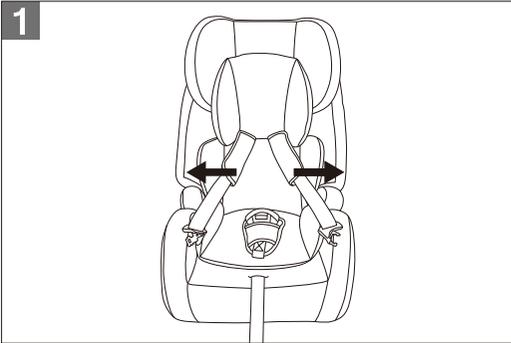
肩ベルトをゆるめて、バックルからタンクを外し、肩ベルトを左右に広げ、お子さまを深く座らせる。
