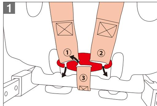
1 背面にあるカバーのファスナーを開き、肩ベルト連結金具と2本の肩ベルト (1、2) と調節ベルト (3) を矢印の方向に外す。
