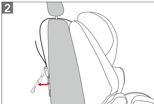
2 トップテザーをトップテザー取付け金具から取外す。
