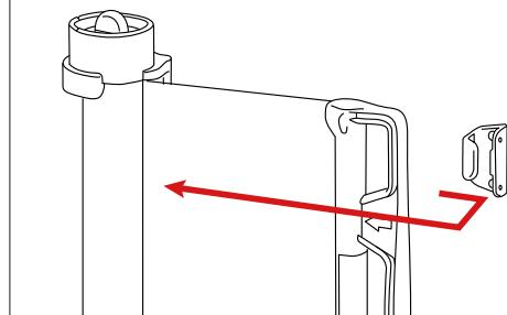
ゲートのフックを外し、ゲートを巻き戻す。
