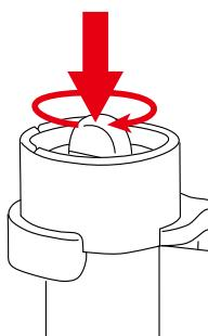
ツマミを押しながら右に回してゲートのロックを解除する。
