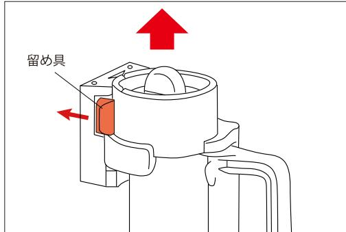
留め具を壁方向に押し、ゲートを上方向に引き抜く。
