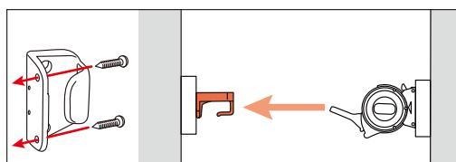
図のように取り付ける場合は、フックの狭い方の面を補助板に固定する。
