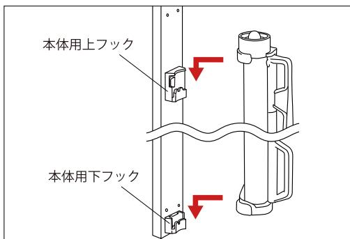
ロックポジションを合わせて、上下のフックに同時に引っかけて押し下げる。
