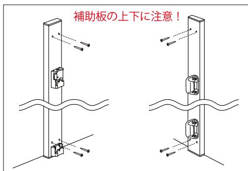
取付け場所の床と補助板の接地面をぴったり合わせ、壁面に補助板取付け用ネジで留める。
