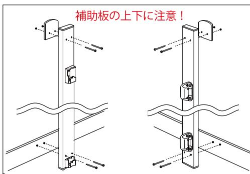
補助板と壁の間にすき間が出来ないよう幅木用プレートを挟んでネジで留める。
