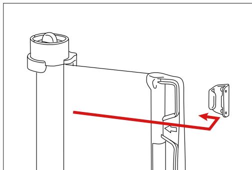
ゲートを引き出し、上下のロックキャッチをしっかりと開閉側フックに引っかけ、大きなタワミがないことを確認する。
