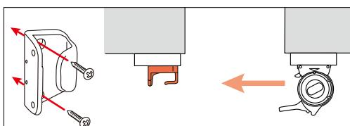
図のように取り付ける場合は、フックの広い方の面を補助板に固定する。
