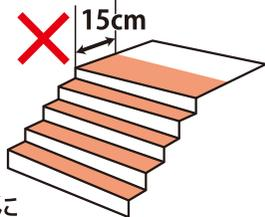
誤ってロールネットが開いた場合、降り口のすぐ近くに設置していると、階段や段差の上から転げ落ちる原因となり大変危険です。
