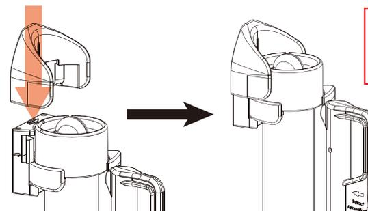
上部カバーを取り付けることによりゲート本体が固定され、ロックがかかります。
