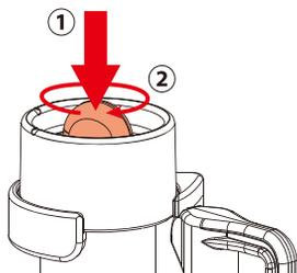
②ゲートのフックを外し、ゲートを巻き戻します。この時、巻き戻っていることのお知らせするため音がします。
