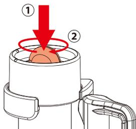
②ゲートを引き出し①、上下のロックキャッチをしっかりと開閉側フックに引っ掛けて下さい②。また、大きなタワミが無いことを確認して下さい。ゲートは自動的に閉状態でロックがかかります。
