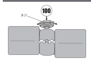
設置する形状に合わせてジョイントパー ツの角度を調節します。
