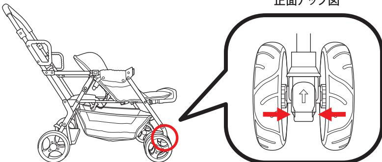
1. 解除ボタンを両サイドから押し込み 前輪を下方向に引っ張って外してください。
